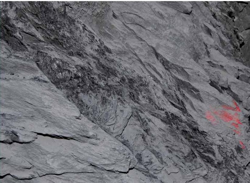
2 Die Störungszone (Bildidiagonale) im Opalinuston, die im Felslabor Mont Terri beim Tunnelbau durchfahren wurde, ist komplett trocken.
