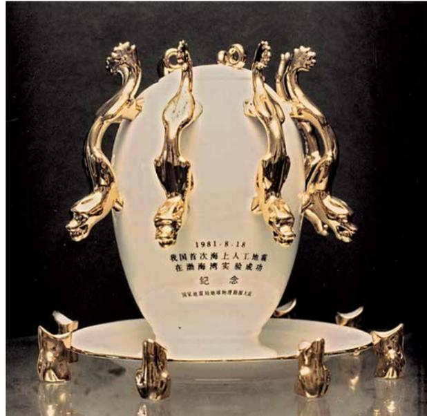
**1** Verkleinertes Modell eines chinesischen Seismoskops. Jeder der hängenden Drachen hält in seinem Maul eine Kugel. Nach einem Beben zeigt die herausgefallene Kugel die Richtung an, in der das Epizentrum liegt.
